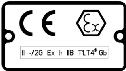
Figura 10: Placa de identificación típica de una bomba ATEX
